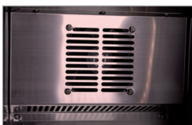
Sistema di aerazione con ventola assiale Axial ventilation system
